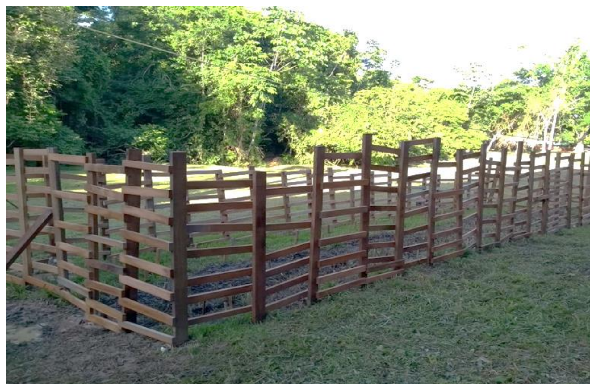
Figura 3 – Campo de apodrecimento dos colmos de bambu, localizado no campus da Universidade Federal do Acre.
