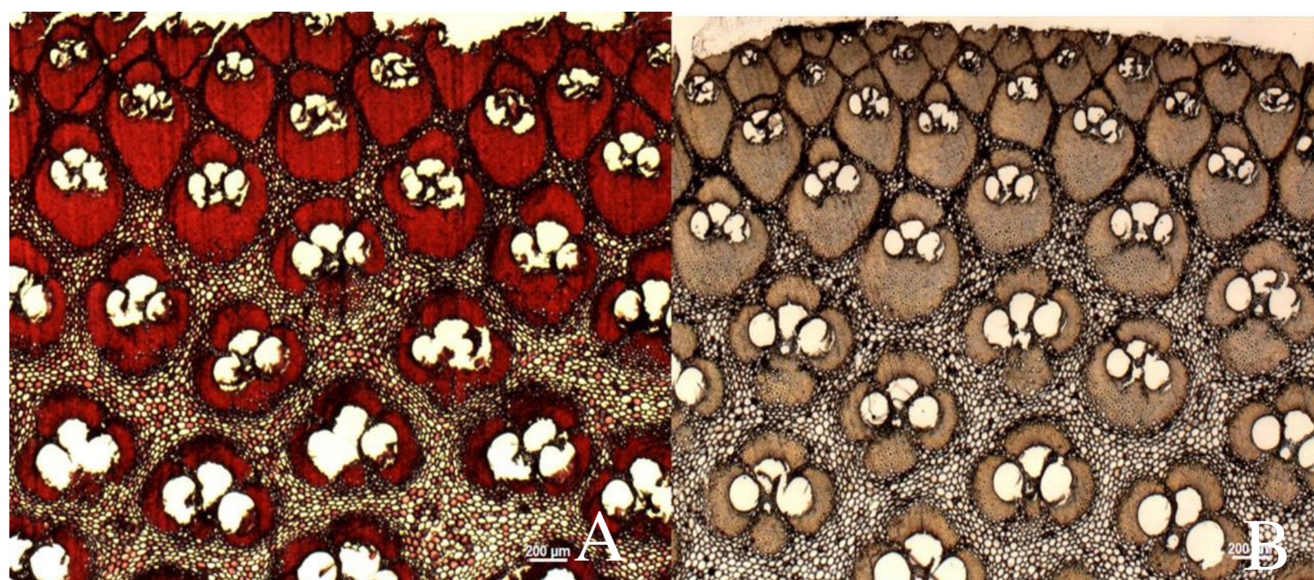
Figura 5 - Corte transversal do colmo de Guadua sp. (Tratamento com água e sal). Coloração com safranina (A) e com Lugol (B).
