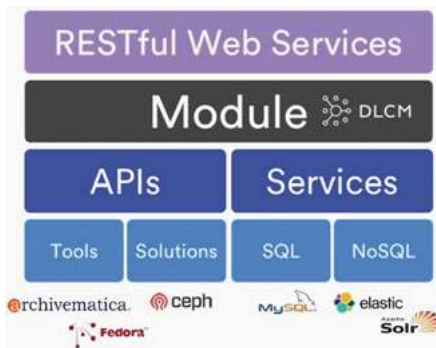
Fig. 3 : Organisation des modules OAIS en services Web. 13 L'approche modulaire, basée sur les Application Programming Interfaces (API) et des Web services, permet de rendre l'architecture évolutive en fonction des technologies disponibles sur le marché (e.g. archivematica, ceph, Fedora Commons etc.).
