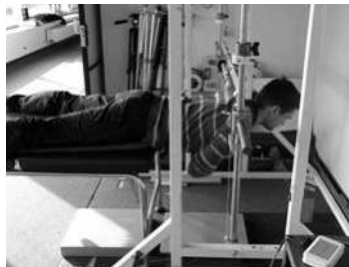
Abbildung 15: Isometrische Kraftmessung der Rumpfextensoren.
