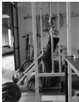
Abbildung 18: Isometrische Kraftmessung der Knie- und Hüftextensoren.
