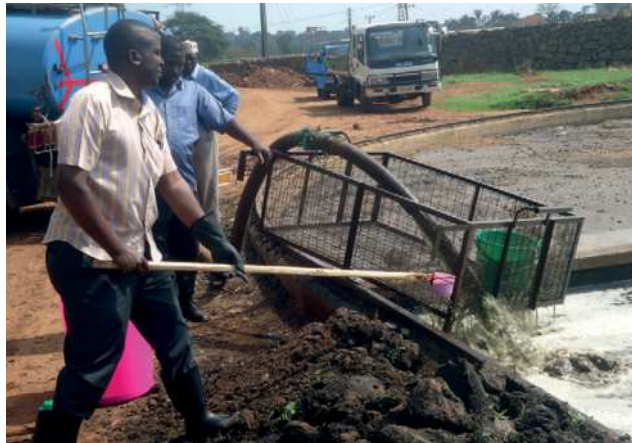
Figure 2.5 : Dégriillage de déchets solides de boues de vidange à l'entrée d'une station de traitement lors d'une campagne de prélèvement à Kampala, Ouganda (photo : Daniel Ddiba).
