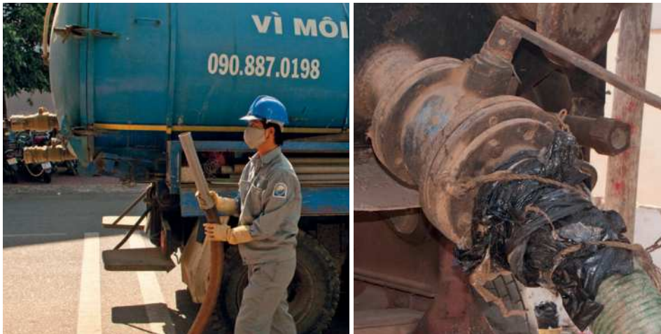
Figure 4.12 (gauche) : Exemple de bonne pratique où l'assemblage des tuyaux flexibles est aisé et rapide (photo : Linda Strande).
