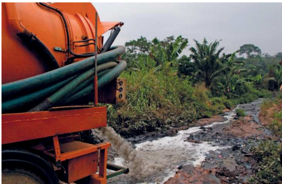
Figure 12.3 : Dépotage illégal de boues de vidange directement dans l'environnement, Yaoundé, Cameroun (photo : Linda Strande).
