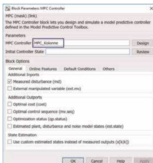
Bild 48. Eingabemaske des “MPC Controller”-Bausteins.
