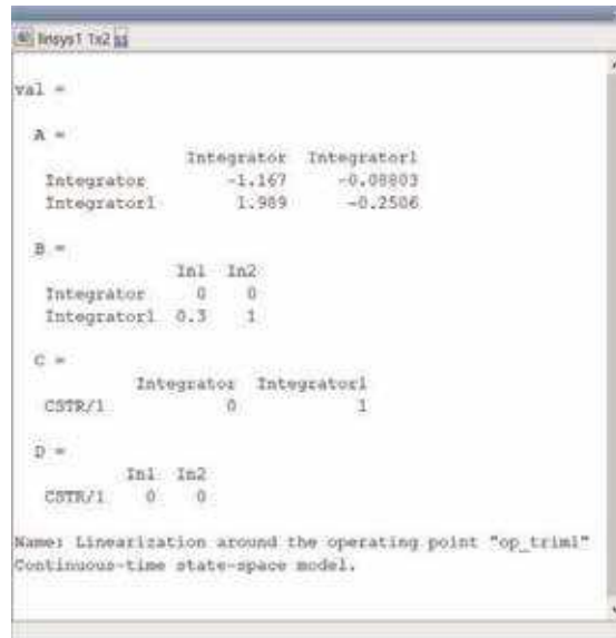
Bild 146. Parameter des linearen Zustandsmodells "linsys1".
