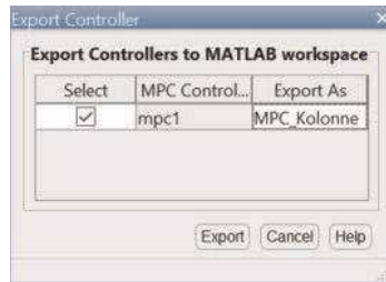
Bild 45. Exportieren des MPC-Reglers für die Pilot-Destillationskolonne in den MATLAB-Arbeitspeicher.
