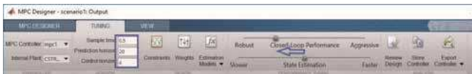
Bild 152. Horizontlängen und Reglereinstellung für den MPC-Regler des CSTR.
