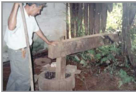
Figuras 6 e 7: monjolo (Nova Ponte, MG). Fonte: fotos de Lourenço, L. A. B. (2002)
