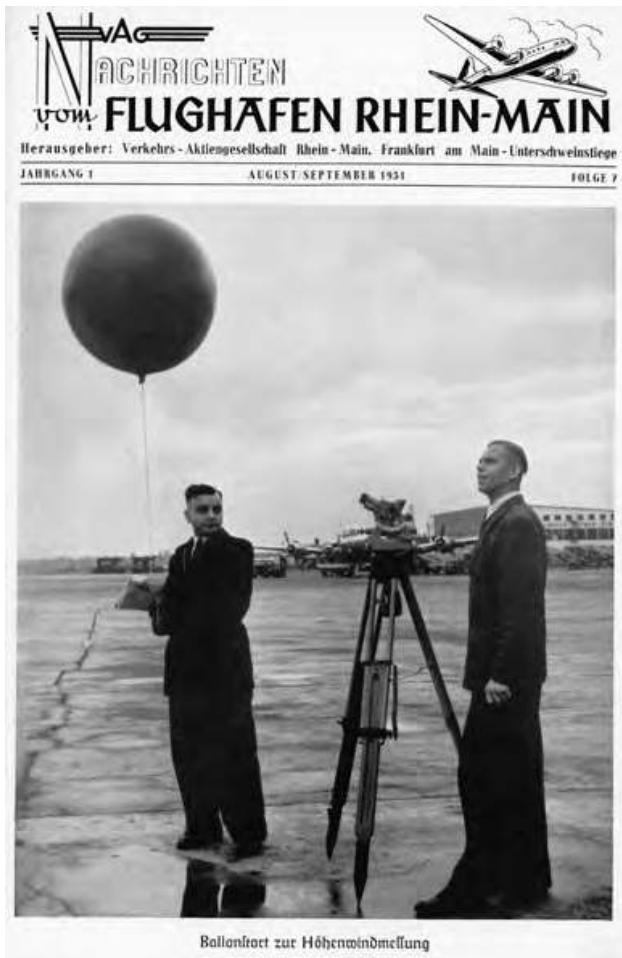
Abb. 16: Höhenwindmessungen am Flughafen – Titelblatt der Ausgabe der Nachrichten vom Flughafen Rhein-Main vom Sommer 1951.
