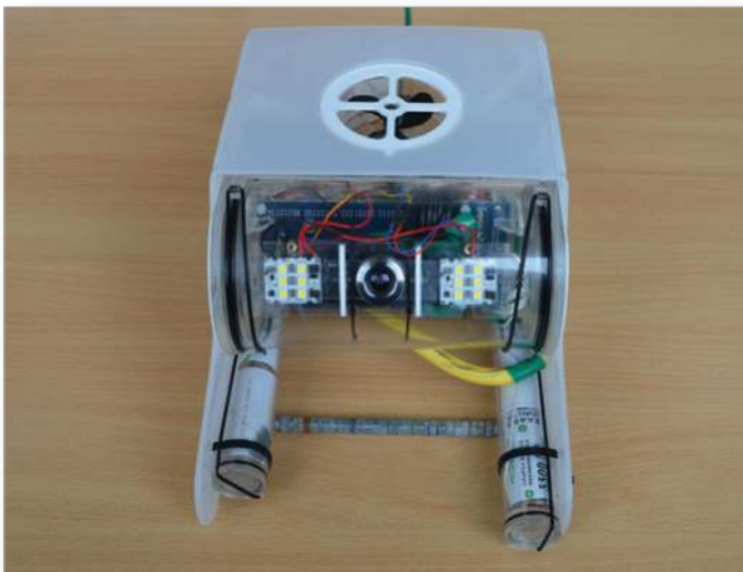
Рис. 25. Дистанционно управляемое устройство openROV v 2.7 для наблюдений за пещерной ихтиофауной в естественной среде обитания. (Фото: Брайан Циммерман, ZSL)
