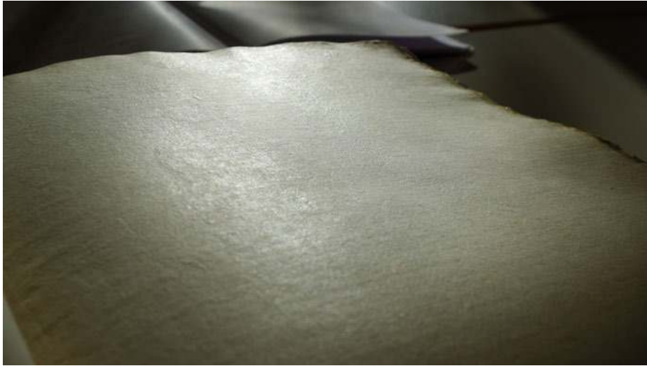
Abb. 13: Im Streiflicht glänzende Papieroberfläche als Hinweis auf die Glutinleimung, StR, Bü 42, Steuerbuch 1473–1476, Foto: Johannes Follmer 2013.
