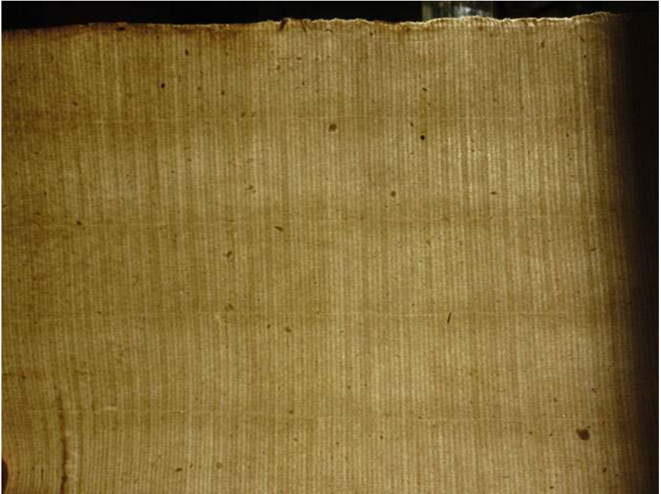
Abb. 4: Durch Faserknoten entstandene Melierungen im Papier, StR, Bü 45, Steuerbuch 1497–1499, Foto: Johannes Follmer 2013.
