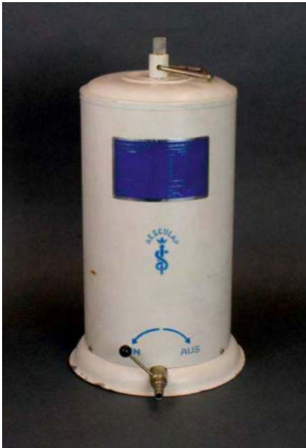
E 0399,0003 Spirometer. DOMiD-Archiv, Köln Dieses Messgerät wurde Anfang der 1970er-Jahre bei den Gesundheitsuntersuchungen in der Deutschen Verbindungsstelle in Istanbul zur Überprüfung der Lungenfunktion bzw. der Vitalkapazität der Bewerber*innen für den deutschen Arbeitsmarkt verwendet.
