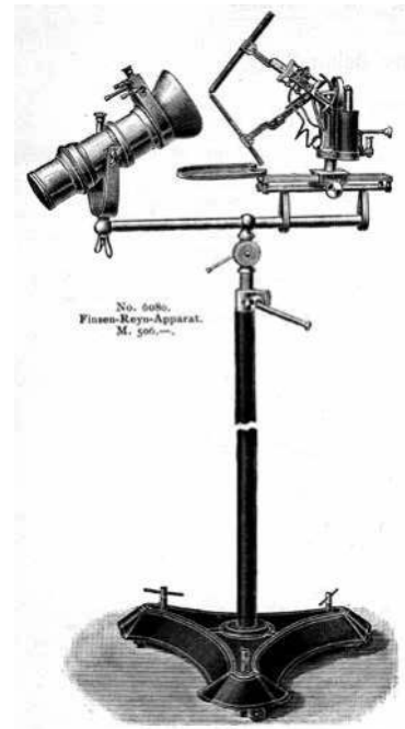
Abb. 6: Darstellung einer Finsen-Reyn-Lampe. Der Sammelapparat befindet sich links, die Lichtquelle rechts. Aus einem Verkaufskatalog, 1905. (Reiniger, Gebbert & Schall: Apparate, S. 394)
