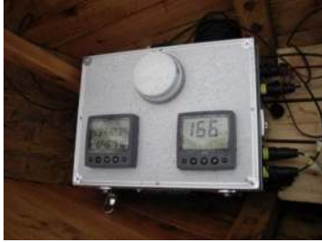
Abb. 11: Instrumentenkoffer mit Server und GPS
