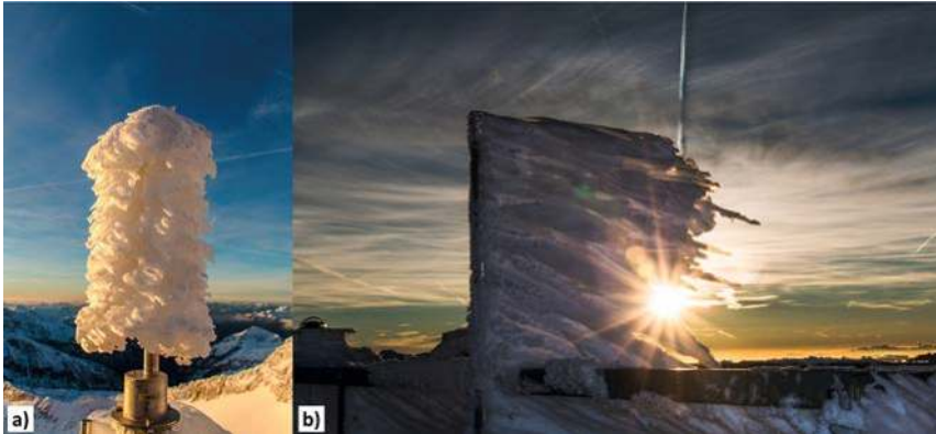
Abbildung 07: Eislastmessung am Sonnblick: mittels rotierendem IceMonitor von Combitech (a), Raureiffahne an einem festen baugleichen Zylinder (50 cm Länge, 3 cm Durchmesser) (b), 23. 11. 2016. Im Zuge einer Südwestwetterlage wurden knapp über 11 kg/50 cm und eine maximalen Raureiffahne von 35 cm erreicht.
