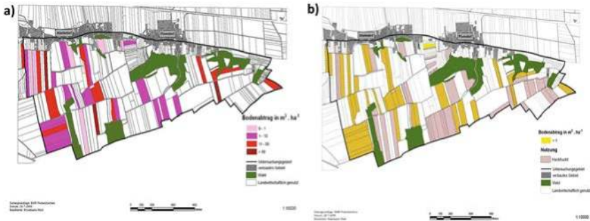
Abbildung 03: Ausmaß der Erosionsschäden im Raum Michelhausen/NÖ (a) nach dem Niederschlagsereignis vom 04.06.2008 und Verbindung der auftretenden Erosionsschäden zum Anbau von Hackfrüchten (b).
