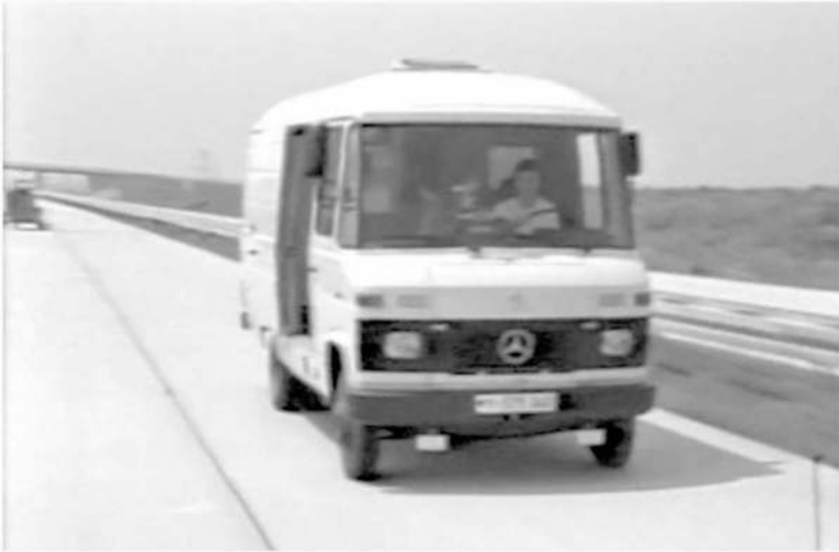
Abbildung 2: Die Kameraplattform im Versuchsfahrzeug für autonome Mobilität und Rechnersehen (VaMoRs) 1986
