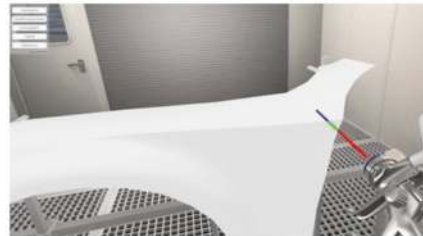
2.6 just-in-time-Information; Strahl, der Abstand zwischen Werkstück und Lackierpistole indiziert
