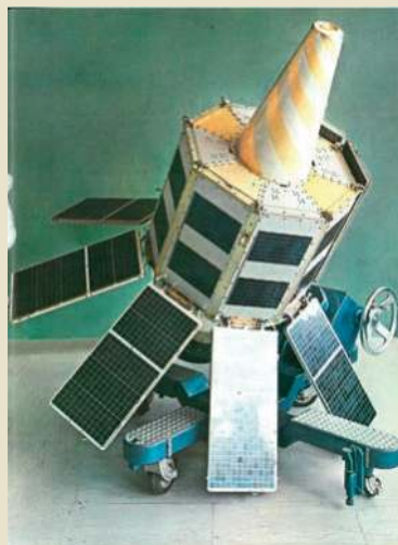
Le satellite Eole qui doit permettre la mise au point d'un programme d'applications météorologiques. « France, recherche et industrie », DGRST, 1970, 123 p., p. 65. © Office national d'études et de recherches aérospatiales.
