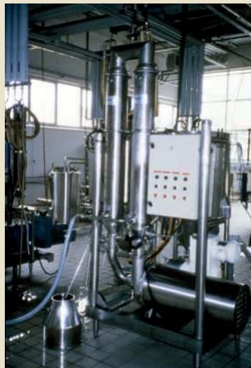
Unité de microfiltration, procédé MMV, Centre Inra de Rennes. © Inra/Patrick Boyaval.
