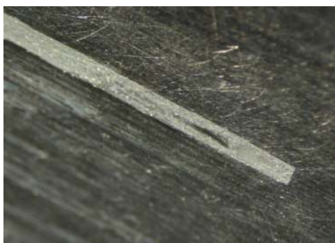
Abbildung 4.8: In Nut eingeklebtes Mantelthermoelement
