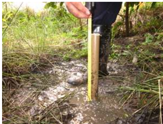
Figura 7-4. Mensuração de estaca de sedimentação. Foto: Clemente Coelho-Jr.
