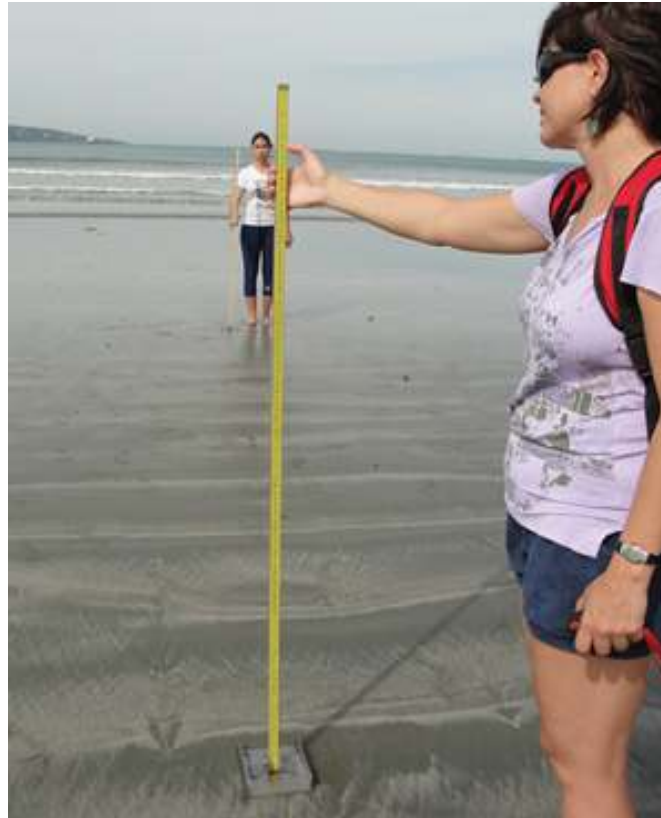
Figura 14-II-2. Exemplo de medição de perfil praiar, segundo método de Emery (1961). Foto: G.S.C. Monteiro
