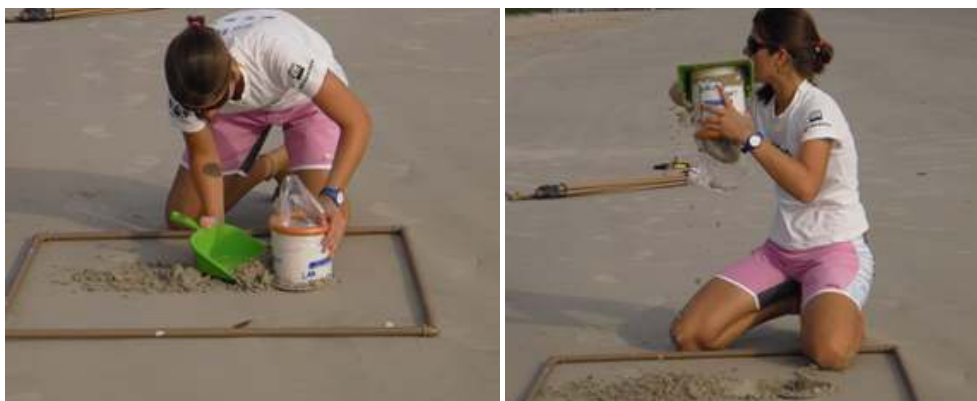
Figura 20-3. Procedimento de coleta de Bledius com utilização do amostrador de 15 cm de diâmetro, adição de saco plástico na extremidade livre e pá na base do amostrador.
