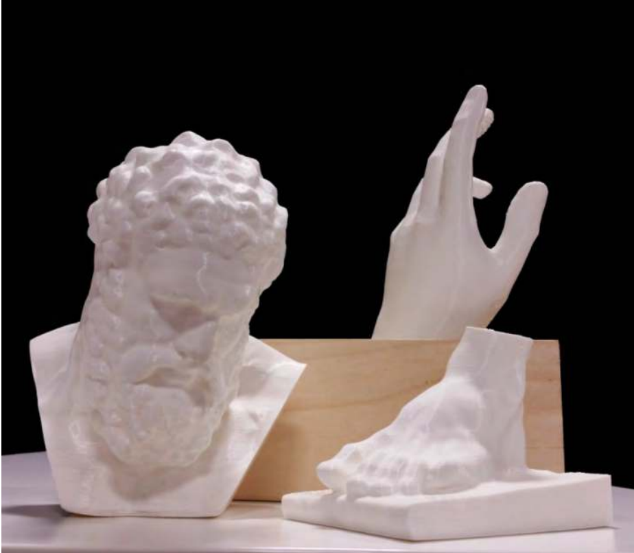
fig. 5 – Frammenti anatomicamente compiuti dell'Ercole Farnese riprodotti mediante stampa additiva 3D in PLA.
