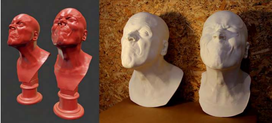
Fig. 8 – Modelli digitali delle due teste (a sinistra) e modelli fisici dopo la stampa 3D (a destra) (elab. R. Camponogara).
