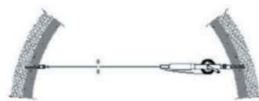
Ilustración 1: Esquema de colocación de cinta extensométrica entre dos pernos
