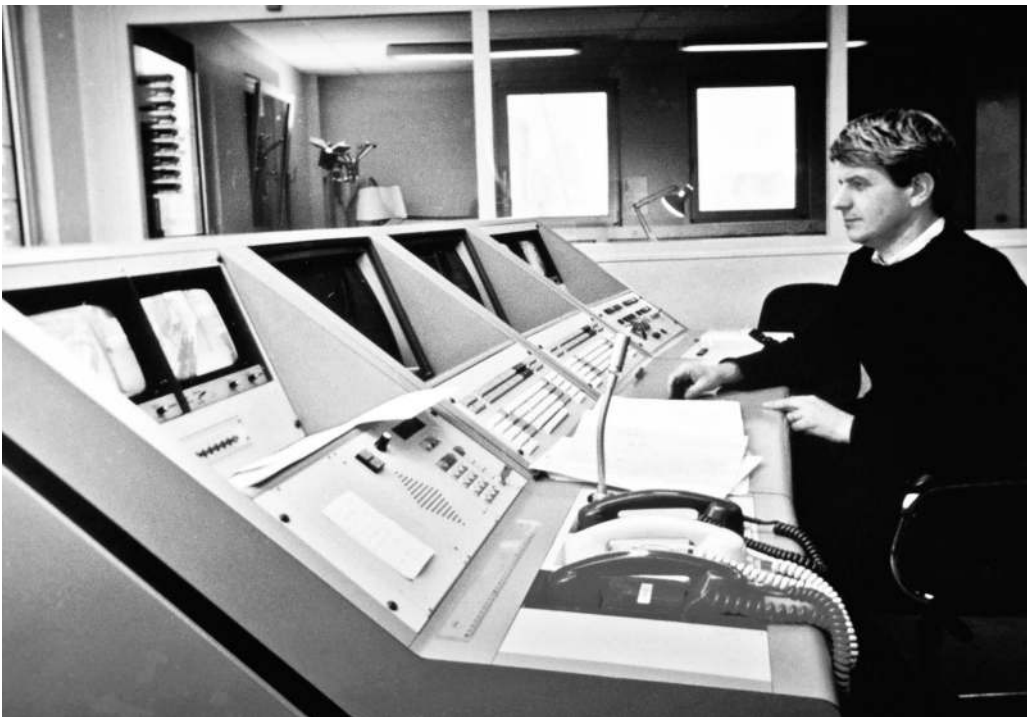
Foto Nr. 14: Der zentrale Leitstand von Aramis, am Boulevard Victor. Wie beim VAL (Foto 7) sollte das vollautomatische System menschliche Akteure nur an den beiden Endpunkten haben: die Fahrgäste in ihren Kabinen und den Kontrolleur an seinem Steuerpult. (Foto: Matra)
