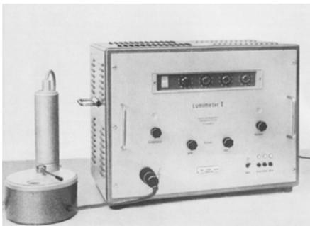
*Abb. V.5: Auswertgerät für das Thermolumineszenzdosimeter „Lumimeter II“*
