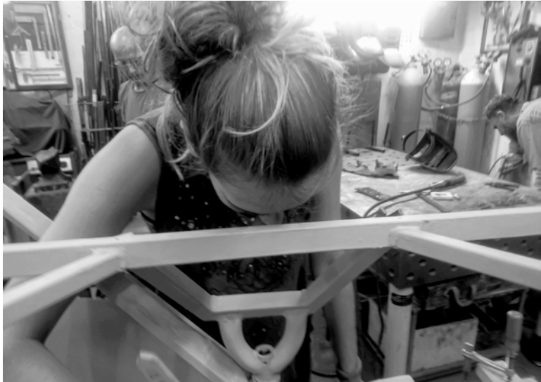
Abb. 43 und 44: Momentaufnahmen beim Abschleifen der Karrosserie
