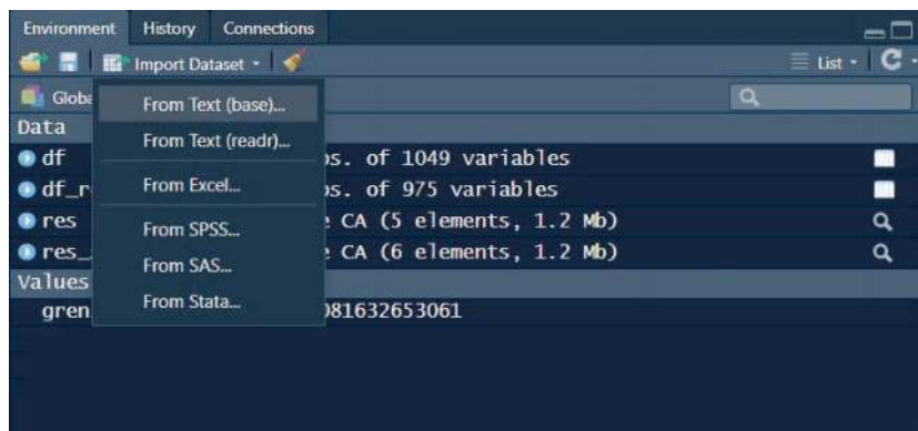
Abbildung 9.5 Menüführung für den Import tabellarischer Datenformate und DataFrames aus SPSS, SAS und Stata
