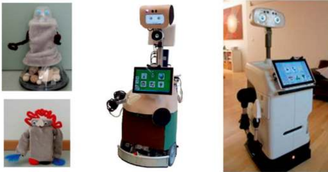
Abbildung 3: Hobbit Roboter in verschiedenen Entwicklungsphasen: Konzeptwürfe, erster Prototyp für Laborstudie, zweiter Prototyp wie er in Privathaushalten zum Einsatz kam (vlnr. © TU Wien)
