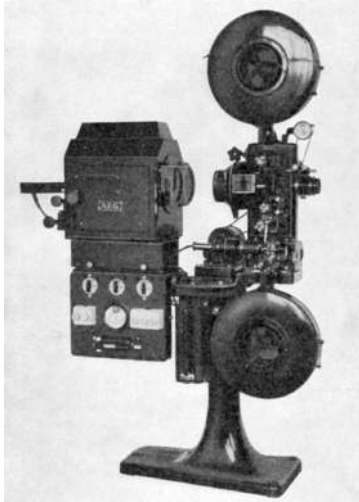
Fig. 99: An AEG projector for 35 mm film with an optical sound projector by Klangfilm GmbH, printed in Fritz Fischer and Hugo Lichte (eds.): Tonfilm. Aufnahme und Wiedergabe nach dem Klangfilm-Verfahren (System Klangfilm-Tobis) , Leipzig: Hirzel 1931, fig. 242. Source: Austrian Central Library for Physics (Vienna), 1755.
