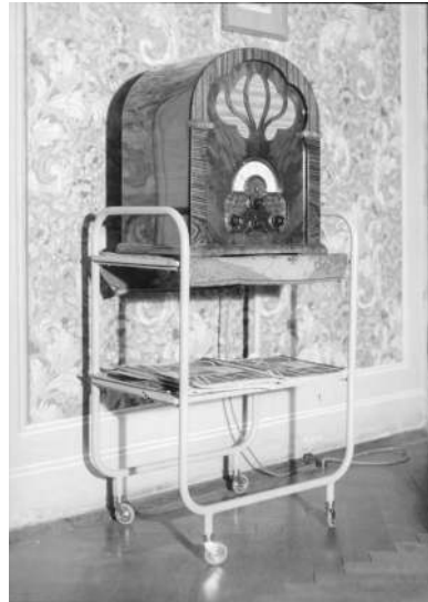
Abb. 116: Sechsröhren-Radioapparat mit Lautsprecher der Marke Berliner von 1933. Quelle: Österreichische Nationalbibliothek, 223.153-B.
