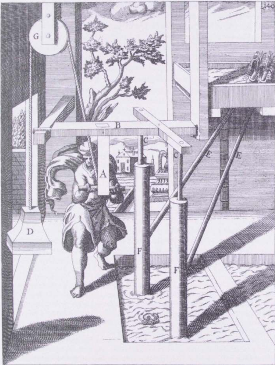
Abb. 114: Darstellung eines Wasserdruckwerks, 1617/1661; Kupferstich aus »Theatrum Machinarum Novum« von G. A. Böckler (1661).
