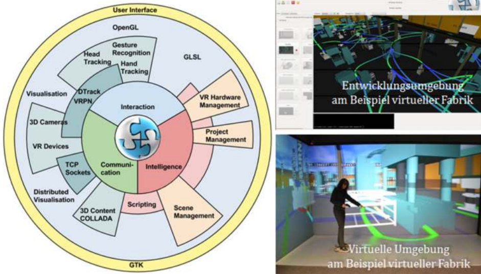
Abb. 3 Software-Architektur und Arbeitsumgebungen der PolyVR-Software, Quelle: Eigene Darstellung
