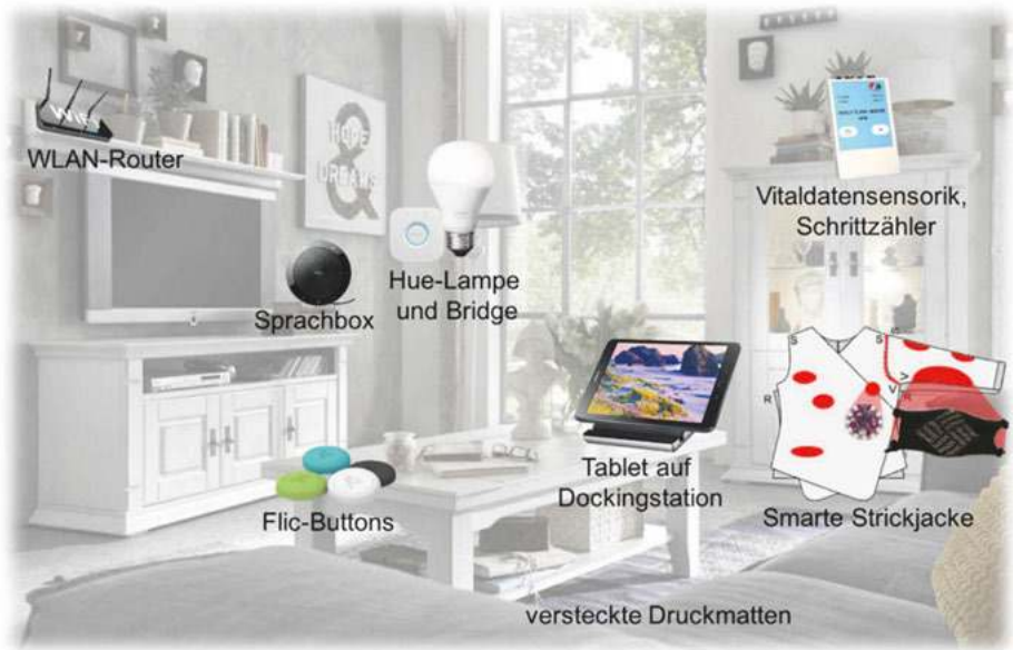
Abb. 1: Überblick der Sensorik und Aktorik (Schumacher et al. 2017)
