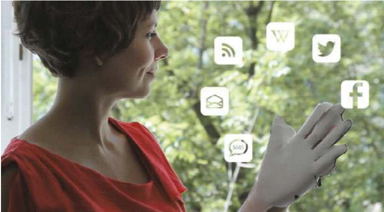
Abb. 4: Die Texteingabe verläuft über die Handinnenfläche mit Hilfe sensorischer Flächen. Die Ausgabe verläuft über die Innenseite mit Hilfe kleiner Vibrationsmotoren.
